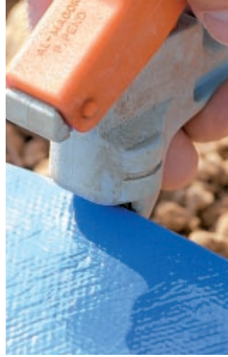
In der Zuflussleitung werden mit der Zange Löcher gemacht.
