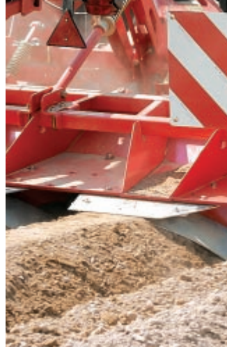
... oder mit einem Dammformer eingezogen werden.
