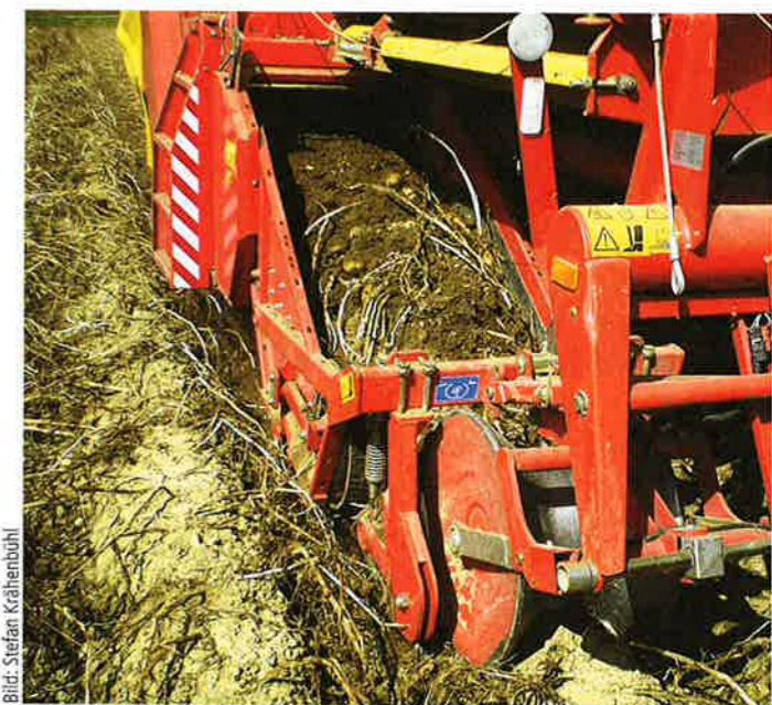
Schonendes Ernten steht im Widerspruch mit hoher Ernteleistung. Dank reduzierter Siebkettengeschwindigkeit wird mehr Erde als Polster mitgeführt.
